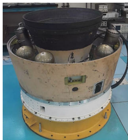
Sistema de atuação por tubeira móvel durante o ensaio Hardware-In-the-Loop (HIL) do SISNAC
