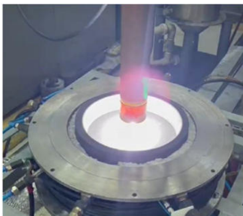
Imagens da Região de Formação do Arco Transferido da Tocha de Plasma (Catodo) para o Anodo
