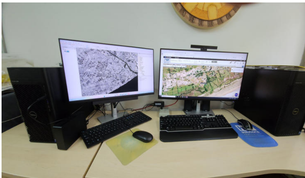
Wokstation de processamento Dinsar, utilizando o software SARsCAPE e imagem do satélite TerraSAR-x.
