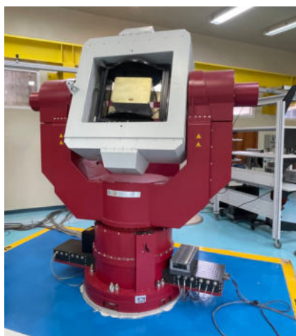
Protótipo do Sistema de Navegação Inercial durante o ensaio Hardware-In-the-Loop (HIL) do SISNAC
