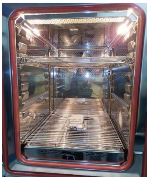
Ensaio Ambientais do Criptocomputador Nacional CM4-B. Ensaio de ciclo térmico (alta e baixa temperatura) em Câmara Térmica.
